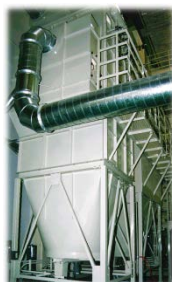
精米プラント用の参考例 ・総処理風量：1,360[m 3 /min] ・電気容量：142.8[kW]
