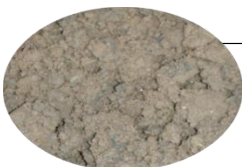
脱水下水汚泥
