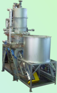
供給器・ガス化炉
